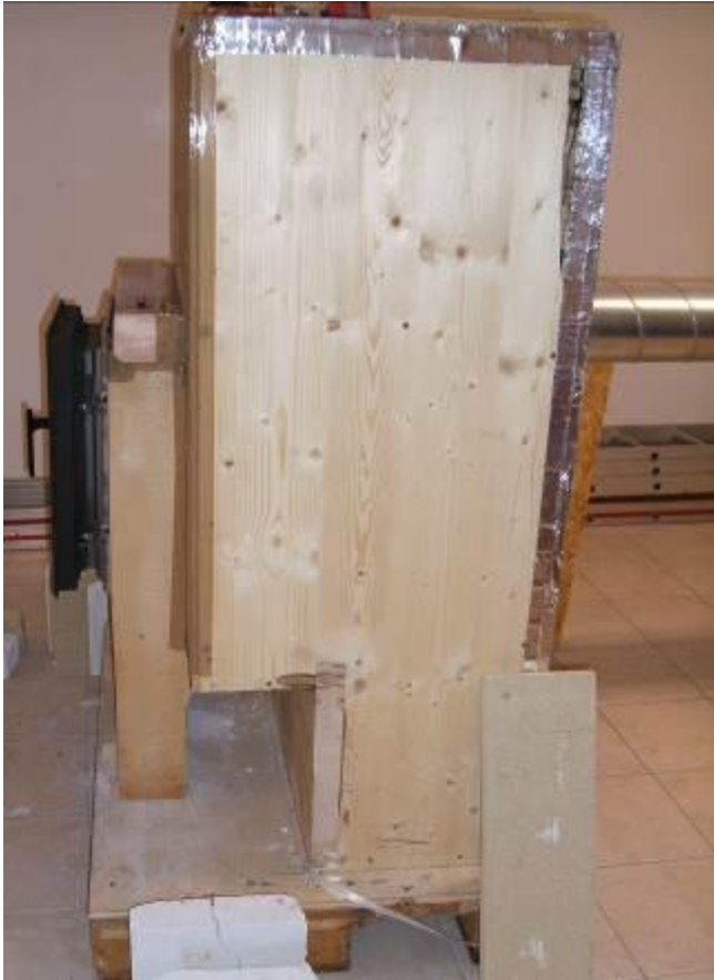
Abbildung 1: Brennraumähnliche, luftdichte Konstruktion zur Aufnahme der Zargen
