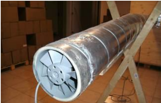
Abbildung 2: Strömungskanal mit drehzahlgesteuertem Unterdruckventilator
