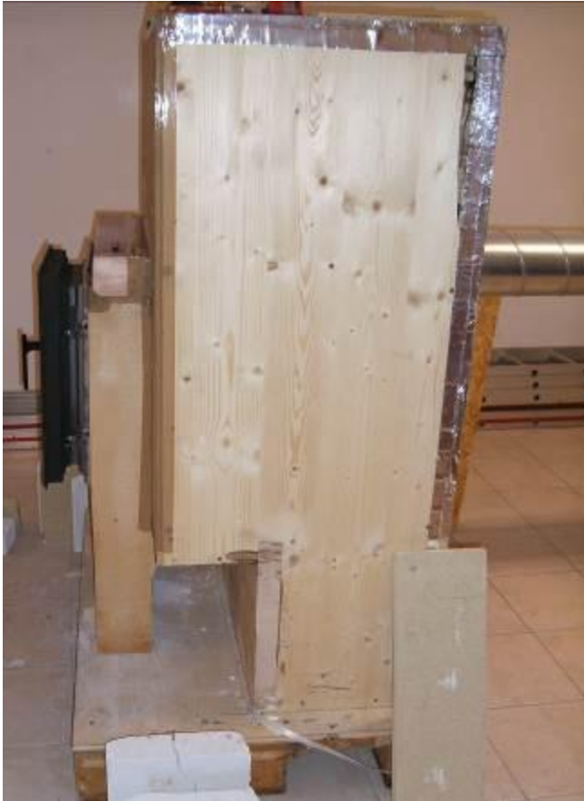
Abbildung 1: Brennraumähnliche, luftdichte Konstruktion zur Aufnahme der Zargen
